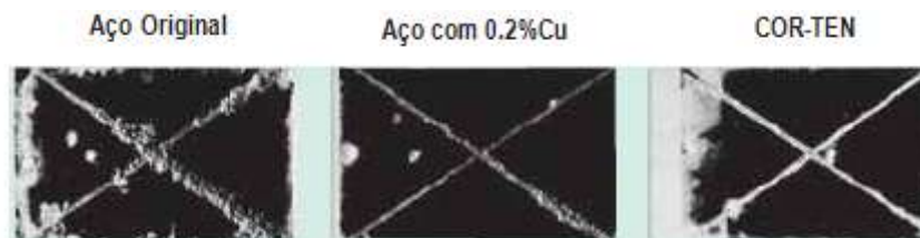
Figura 3 - Diferentes materiais expostos a testes de corrosão (Corporation, 2012)
